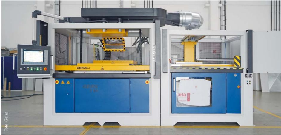
Das Barcodesystem sorgt dafür, dass die zu jedem Produkt hinterlegten Prozessdaten von der Tiefziehmaschine, genauso wie der Fräse, automatisch den richtigen Verarbeitungsprozess für die Schlitten aus verschiedenen Materialien und in unterschiedlichen Farben wählen.
