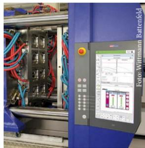
ckaging Deckel aus PP mit einer Zykluszeit von 4,7 s spritzt. Der Side-entry-Roboter legt die IML-Folien ein, entnimmt die folierten Deckel, führt sie in weiterer Folge einer integrierten Kamera zur Prüfung zu und separiert die Gut- und Schlechteile. Kompakte Bauweise und schneller Wechsel von Folien zeichnen diese IML Anlage aus. [sra](http://www.wittmann-group.com)
