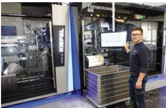
Die letzten Handgriffe sitzen: Martin Mooser, Anwendungstechniker bei Kiefel prüft den Thermorunner KTR 6.1 Speed und ist zufrieden – formen, stanzen, stapeln – alles läuft glatt.
