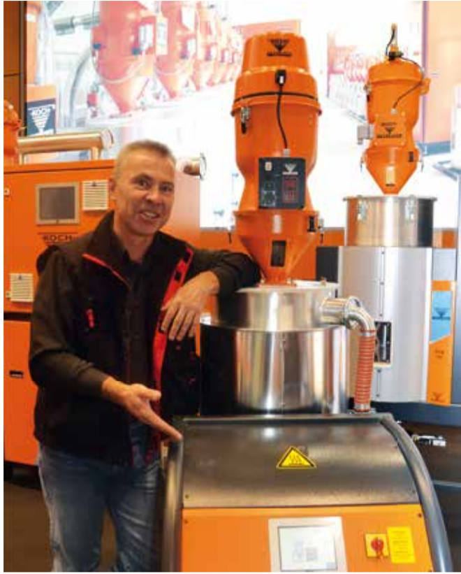
Eduard Müller, Leiter Elektrokonstruktion, am mobilen Trockenlufttrockner KKT, der jetzt eine Touch-Panel-Steuerung hat.
