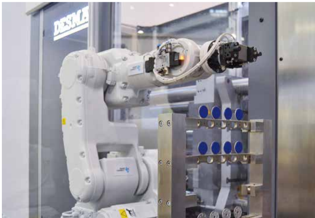
Die Produktion von Schlüsselanhängern aus NBR mit einem Metalleinleger in einer vollautomatischen Fertigungszelle ist am Stand von Desma Elastomertechnik zu sehen.
