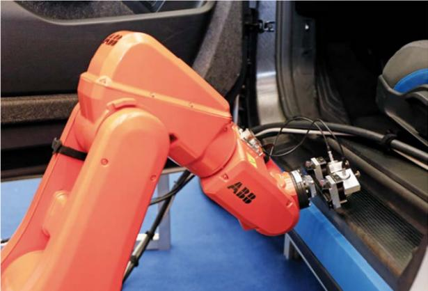
Schaden oder nicht: Der Roboter scannt – und erkennt
