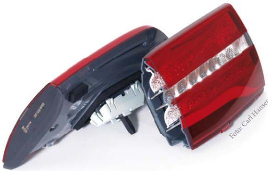
Die Mercedes-Rückleuchte von Odelo eröffnet durch das Hybridlaserschweißen neue Designfreiheiten im Sichtbereich mit kaum sichtbaren Fügezonen. Hierbei werden das Gehäuse aus ABS und die Lichtscheibe aus PMMA jeweils direkt in den Außenkanälen miteinander verschweißt. Dabei entstehen optisch sehr saubere Schweißnähte.
