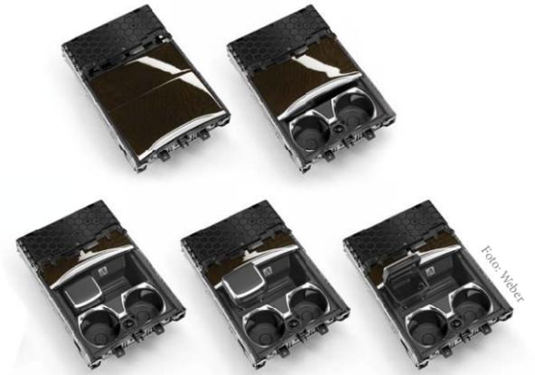
Weber gelingt es, auf kleinstem Bauraum ein Mittelkonsolenmodul mit großem verschließbarem Eingriff zu realisieren und dabei die Steifigkeit der Mittelkonsole noch zu erhöhen. Die Baugruppe besteht aus Doppelcupholder, Steckdose (Zigarettenanzünder) sowie beleuchtetem Ablagefach mit USB-Adapter und additivem mobilem Kinematik-Ascher. Als Material wurden 20 Prozent glasfaserverstärkte PC/ABS-Typen der Marke „Bayblend“, ABS „Cyclac DL 100 sowie TPU „Pearlthane“ 11T85UV (86) verwendet.
