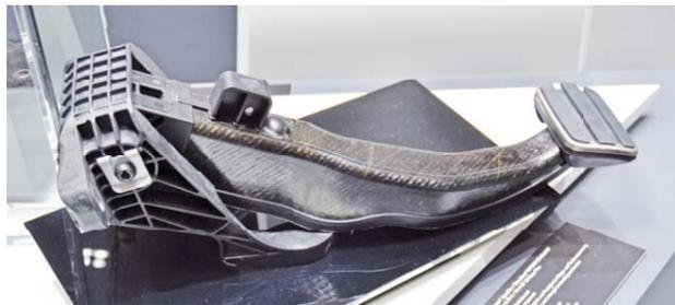
Das durch einen Einleger aus Tepec dynalite verstärkte Vollkunststoff-Bremspedal zeigt sich in einem attraktiven technischen Look.
