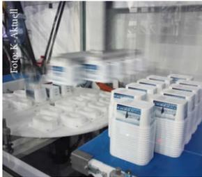
Komplette System-Lösung mit IML-Automation, Seitenentnahme, Kamerakontrolle und Stacker für supermarktaugliche Lebensmittelverpackungen mit IML-Dekoration.
