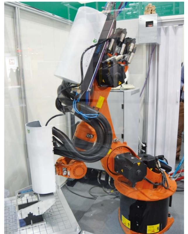
Die Fertigungszelle integriert additive und subtraktive Fertigung.
