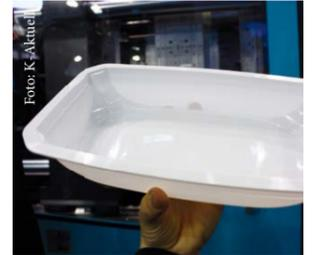
Mit der Spritzprägetechnik werden Verpackungen noch dünner und leichter. Sie spart Material und steigert die Qualität.
