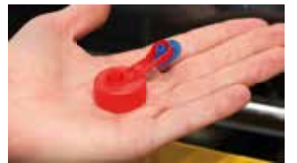
Alle 8,5 s spuckt die Cube-Anlage 32 zweifarbige Flip-Top-Verschlüsse für Pril-Spülmittelflaschen von Henkel aus.
