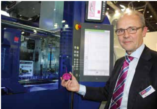
Geschäftsführer Georg Tinschert mit dem direkt im Werkzeug umgeformten und umspritzten Blech-Kunststoff-Demonstrator.
