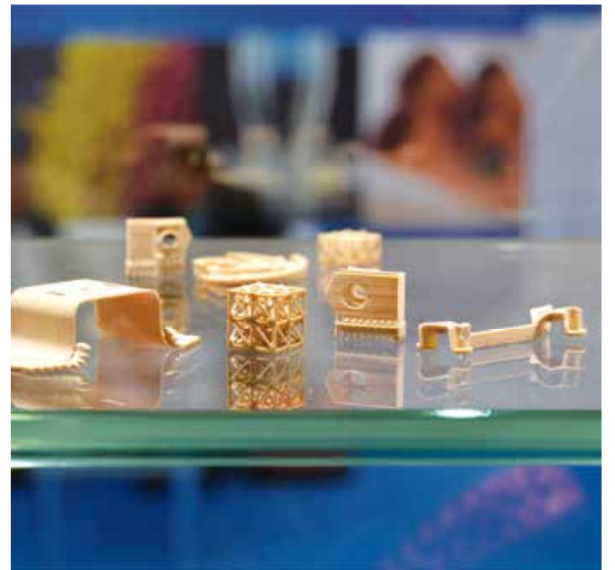
Mit dem Thermomelt-Verfahren hergestellte Strukturteile aus dem PEKK Luvosint.
