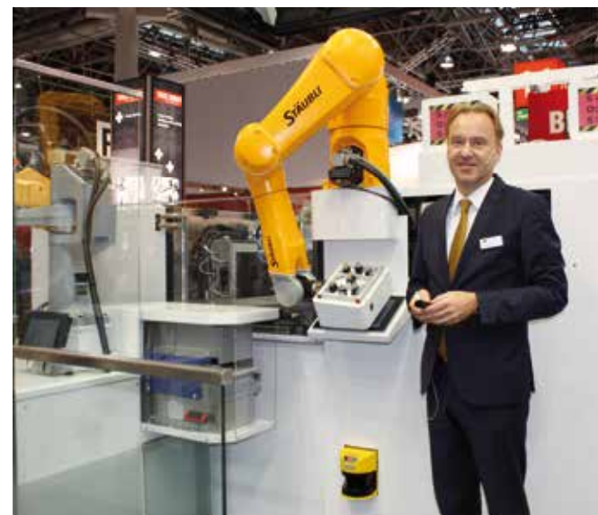
Safety first: Sobald Robotics-Geschäftsführer Gerald Vogt die Sicherheitszone betritt, verlangsamt die Arbeitszelle ihre Bewegungen bis hin zum Stillstand bei Berührung.
