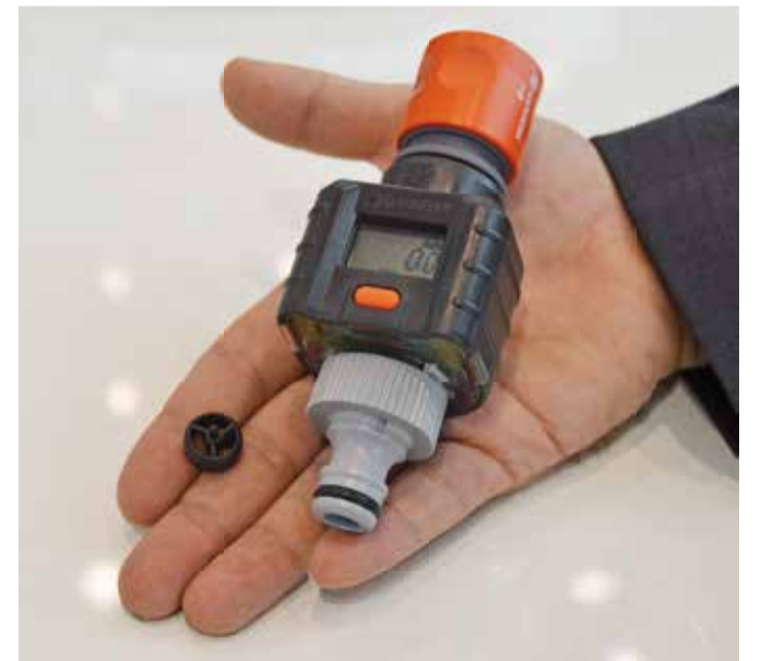
In dem Wasser-Durchflussmesser dient der spritzgegossene Magnet gleichzeitig als Turbinenrad und Signalgeber für die Messung.
