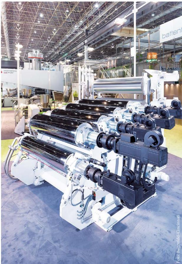
Mit seiner enormen Leistung von bis zu 3 t/h eignet sich das XXL-Glättwerk für Hochleistungsanwendungen in der Verpackungsbranche
