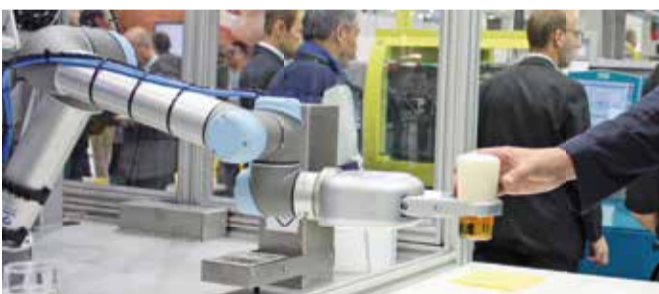
Das gefahrlose Übergeben auch ohne Schutzzaun gehört zu den Vorteilen kollaborierender Roboter.
