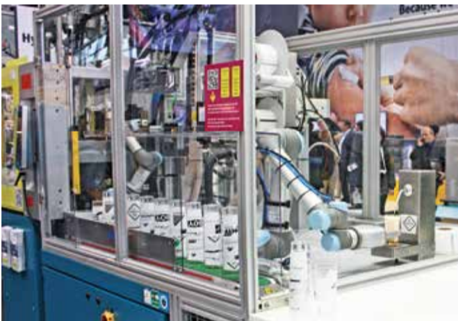
Zwei kollaborierende Leichtbauroboter machen die Boy 35 VV zur vollautomatischen Anlage für die Herstellung, Etikettierung und Befüllung von Trinkbechern.
