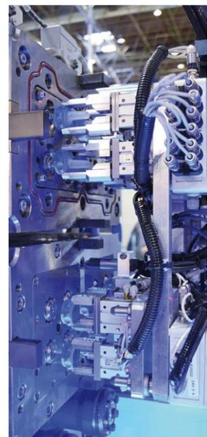
8-fach-Werkzeug mit Umsetztechnik: unten die Vorspritzlinge aus PBT, oben die fertigen Verschlüsse.
