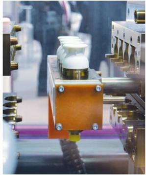
Gemeinsam mit Elmet und Arburg präsentiert Momentive an seinem Stand Zweikomponenten-LSR-Spritzgießen auf einer Einkomponenten-Spritzgießmaschine Allrounder 470 A von Arburg. Der Turnkey-Lieferant Elmet hat eine vollautomatisierte Produktionszelle mit einem 4+4-fach Werkzeug zur Produktion von zweifarbigen Eierbechern konstruiert. Dabei wird die Spritzgießmaschine mit eigenen Peripheriegeräten und eigenem Dosiersystem kombiniert. Als Material dient Silopren LSR
