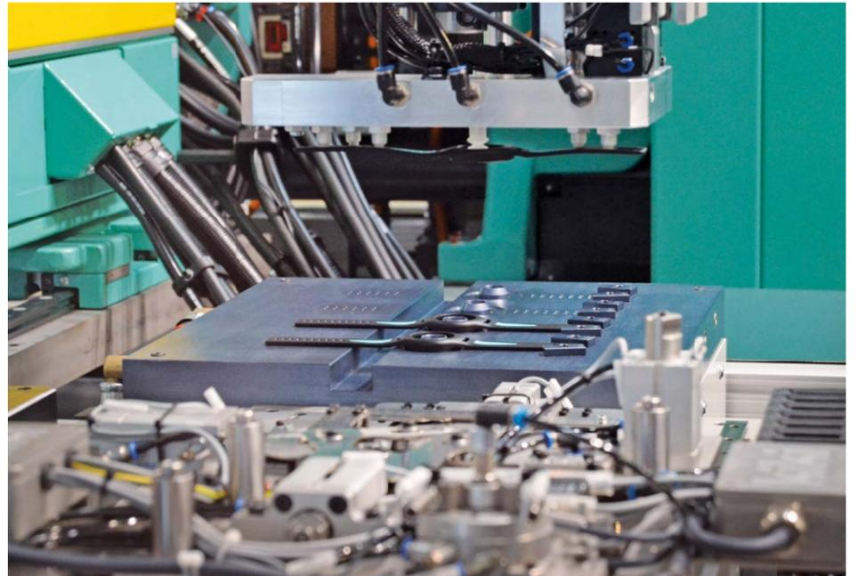
Ein Spreizsystem weitet die Silikonöffnung am Armband mit vier Fingern auf, sodass das Robot-System das Gehäuse einfügen kann. Die Selogi-
