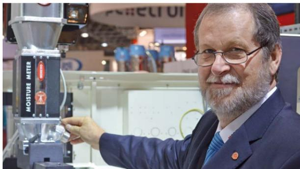
Renato Moretto zeigt das Online-Restfeuchtemessgerät Moisture Meter, mit dem die Herstellung von Kunststoff-Teilen dokumentiert werden kann.
