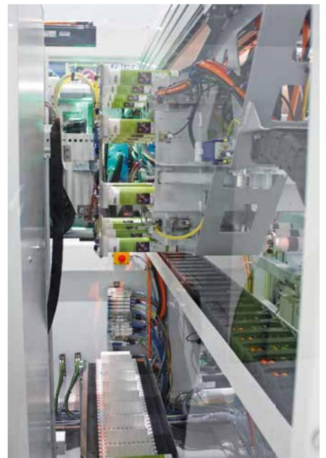
IML als Novum für Kartuschen: Die IML-Automatisierung von Beck ist auf das extreme Durchmesser/Längen-Verhältnis zugeschnitten.
