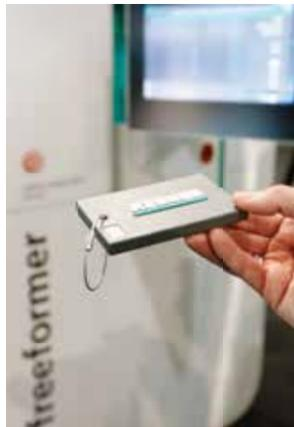
**Vorletzte Station:** Der Freeformer trägt additiv die an der zweiten Station ausgewählte Grafik aus dem Kunststoff TPE in 3D auf.
