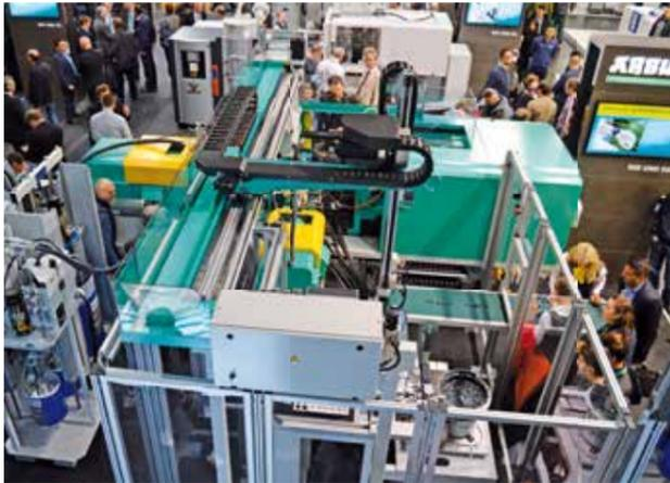
In der vollautomatischen Produktionszelle entstehen Uhren mit einem Armband aus zwei unterschiedlich weichen LSR-Typen.
