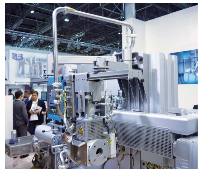
Das flexible Unterwassergranuliersystem Pearlflex ist für Durchsatzleistungen von bis zu 500 kg/h ausgelegt.
