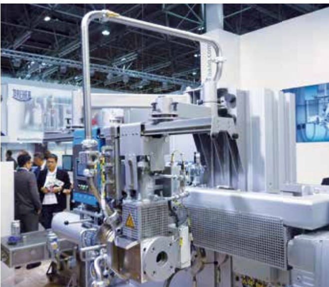
Das flexible Unterwassergranuliersystem Pearlloflex ist für Durchsatzleistungen von bis zu 500 kg/h ausgelegt.
