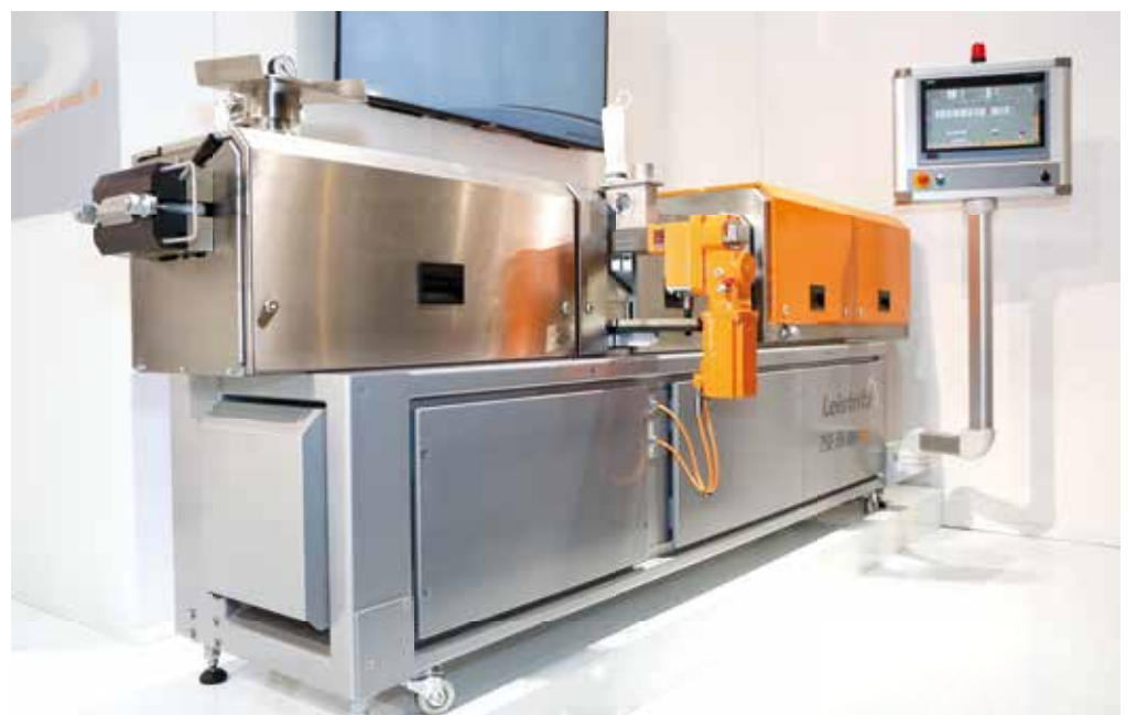
Beim ZSE 35 iMaxx kommt ein Synchronmotor zum Einsatz, der zu einer verbesserten Energieeffizienz beiträgt.
