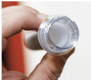
**PET-Preform mit geschäumter Innenschicht: Der Effekt des Schäumens zeigt sich beim Blasen in einer silbrig-metalllicfarbenen Anmutung der Flasche.**
