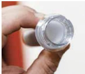
**PET-Preform mit geschäumter Innenschicht: Der Effekt des Schäumens zeigt sich beim Blasformen in einer silbrig-metalllicfarbenen Anmutung der Flasche.**
